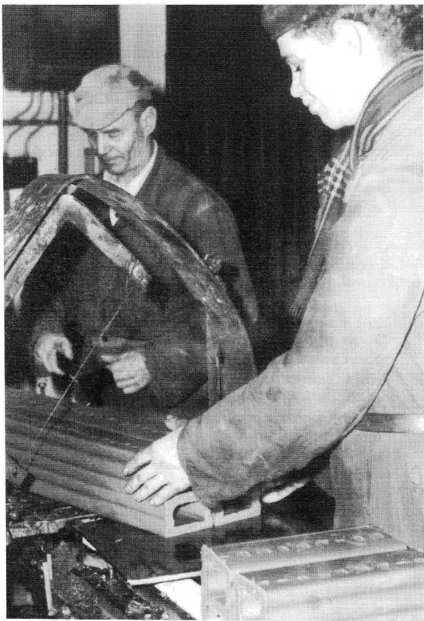
De holle bakstenen worden na vorming door de strengpers op maat afgesneden in de steenfabriek op Oostelaar. Dat gebeurde in de vijftiger jaren nog handmatig. (Collectie: René Hermans-Wouw).
